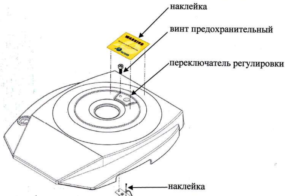
Рисунок 2 - Схема пломбировки весов от несанкционированного доступа
